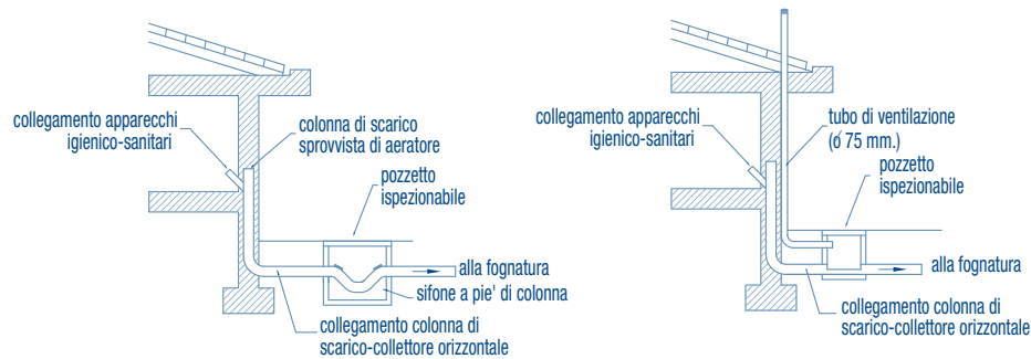
b) fabbricato sprovvisto di aeratore su condotta di scarico
