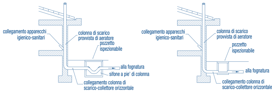
a) fabbricato provvisto di aeratore su condotta di scarico
